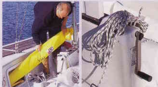
Riesiger, wasserdichter Stauraum: Das aufgerollte Segel passt hinein. Der Kiel lässt sich von einem Kind hochkurbeln
