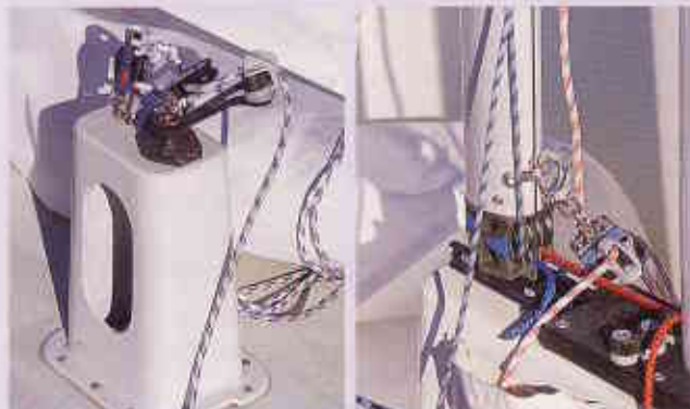
Zentrales Podest für die Großschot mit Stauraum – zwar zweckmäßig, aber leider kein Traveller. Auch der Baumniederholer ist vom Steuermann etwas umständlich zu holen (rechts). Der Trimm wird so schwerer
