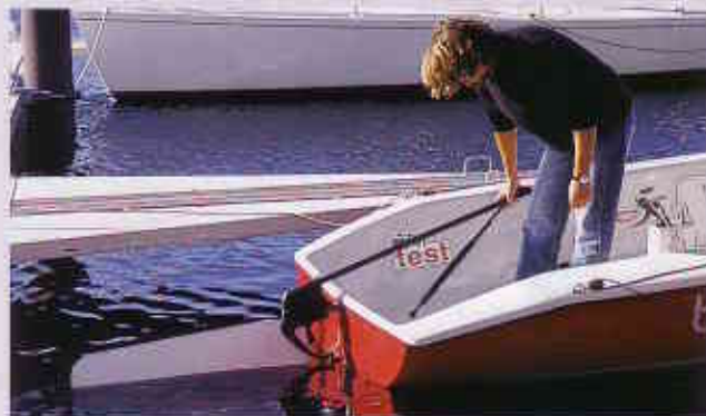
Das Ruder schwingt nach einem kurzen Ruck an der Pinne hoch. Drückt man die Pinne nieder, senkt sich das Blatt
